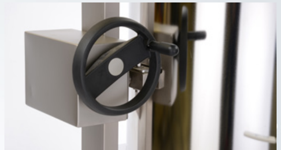
Handrad zur kontrollierten Entleerung
