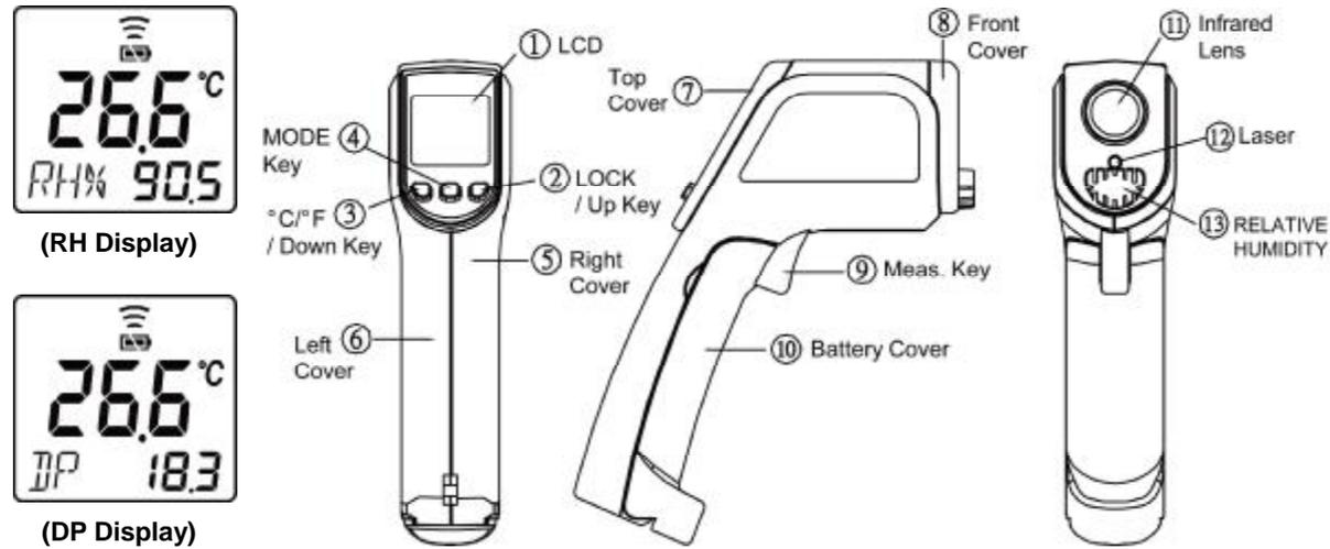
Einfach das zu messende Objekt anvisieren und die Messtaste betätigen. Das Messfleck-Entfernungsverhältnis beträgt 12:1. Stellen Sie sicher das das zu messende Objekt kleiner als der Messfleck ist.
